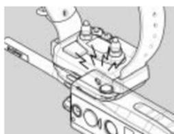
3. Placer le point rouge magnétique situé au dos de l'émetteur sur celui situé sur le collier-récepteur. Maintenez-les ainsi pendant 5 secondes. Lorsque le voyant LED situé sur le collier-récepteur commence à clignoter rapidement, séparer les deux points rouges.
